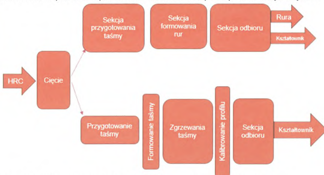
Rysunek 5. Schemat produkcji kształtowników i rur ze szwem zimnoprofilowanych.
